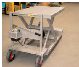
Pompa manuale (ideale per ambienti ATEX)
